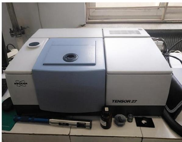
**Fig. 1** FTIR Spectrometer TENSOR27.
